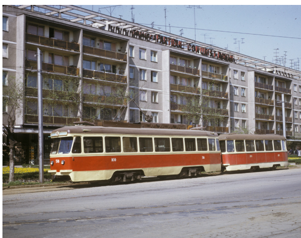
Fig. 25. Garnitura de tramvai, având în componență vagonul automotor de tip EP-V54 – cunoscut de mai vechii orădeni și sub apelativul de „săgeata roșie” – părăsește stația din Piața București (1972)
